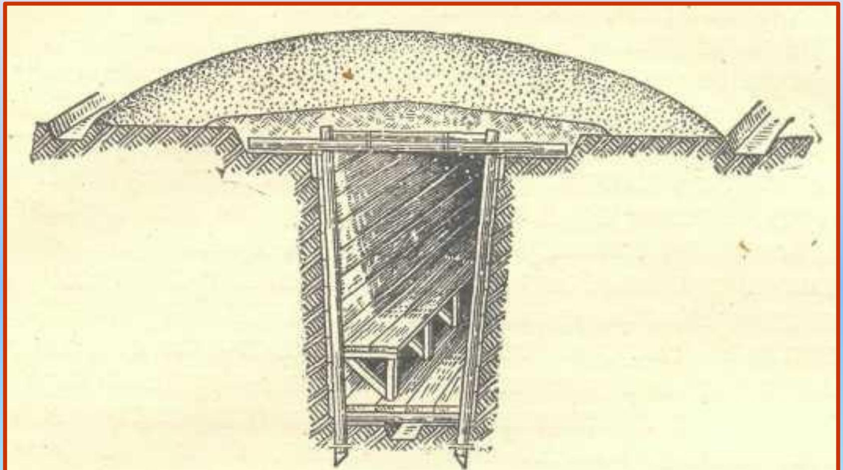
Рис. 8. Общий вид перекрытой щели (в разрезе)
